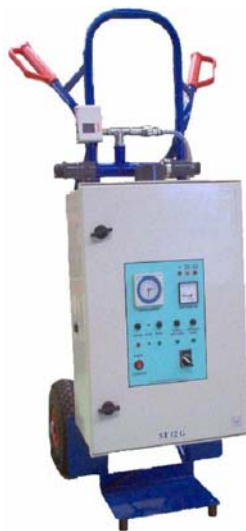
Equipo portátil para lavado con agua ozonizada o tratamiento de ambientes con ozono. Distintas producciones
